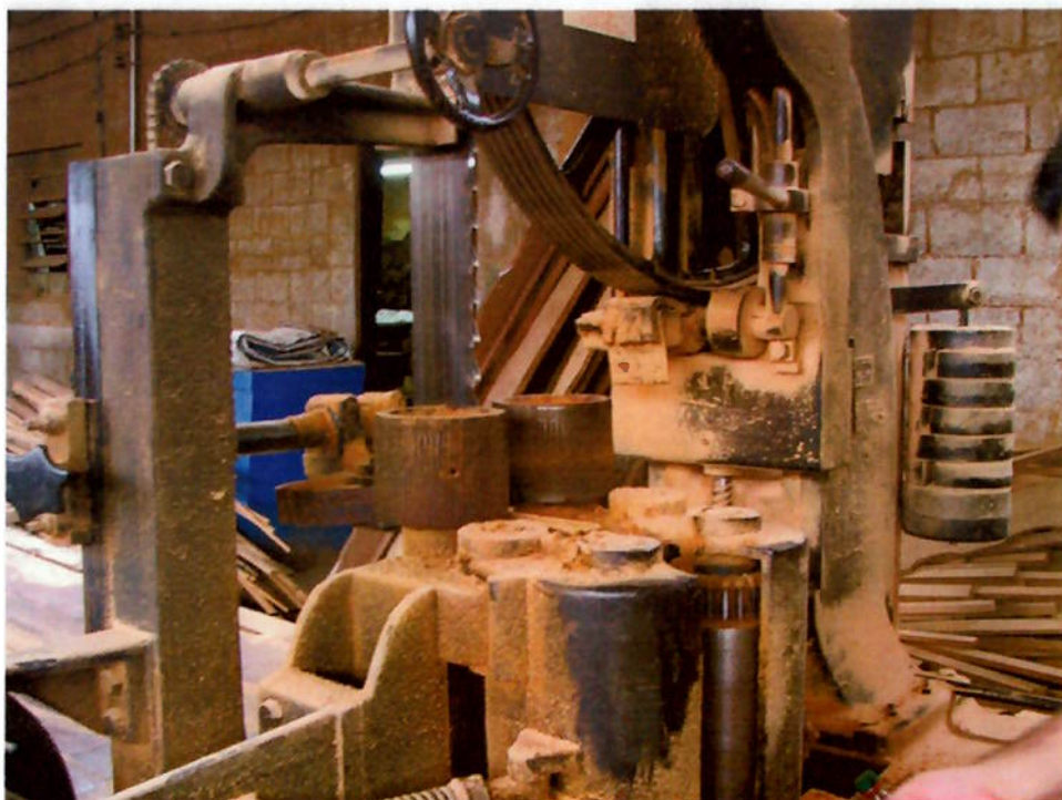
Figura 14. Pó presente nos equipamentos
