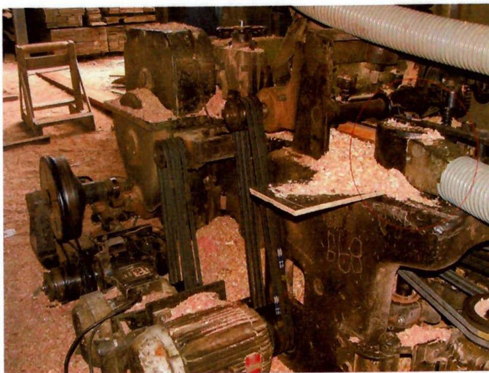
Figura 16. Uma das máquinas com sistema de exaustão
