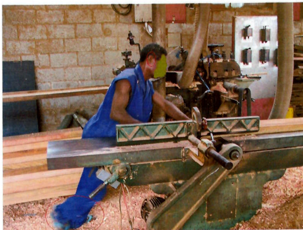
Figura 25. Falta de EPI na execução do trabalho
